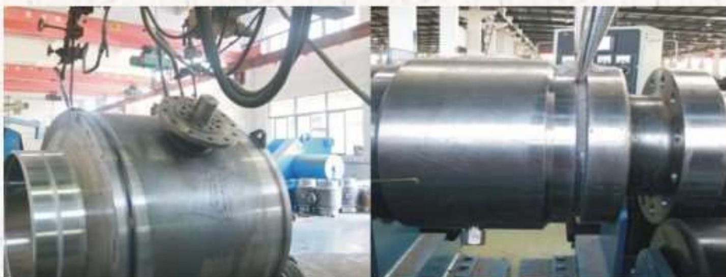
▲ автоматизированный сварочный аппарат
