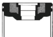
Соединяя материал эластомера с жестким фенолическим прокладным кольцом дизайн SDV400 гарантирует полную поддержку и увеличенную стабильность седла. Это гарантирует надежное управление без перекашивания, особенно в области изоляции стержня, предотвращает все риски утечки.
