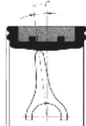
В серии SDV 400 конструкция седла имеет небольшой объем эластомера, набухание минимально, врачающий момент уменьшен и гарантирован более длинный жизненный ресурс.
