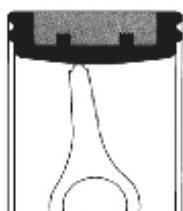
Новый дизайн седла и диска, используемого в конструкции затвора SDV 400, гарантирует сжатие между профилем диска и седлом. Прокатное действие диска в сочетании с устойчивостью седла исключает разрыв или группировки, таким образом, сводя к минимуму повреждение седла.
